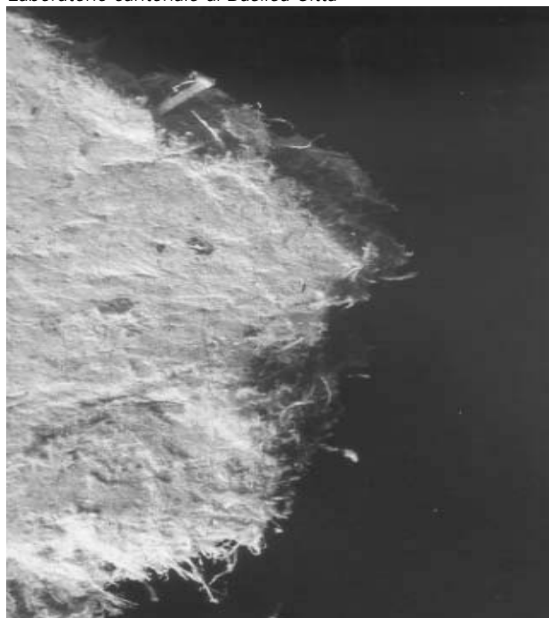
Cartone d'amianto, foto: SA
