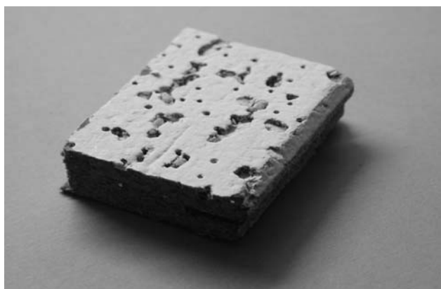
Ingrandimento di un pannello fonoassorbente, foto: IST
