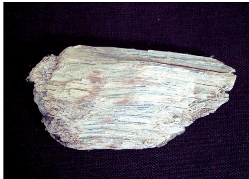
Amiante blanc (chrysotile)
